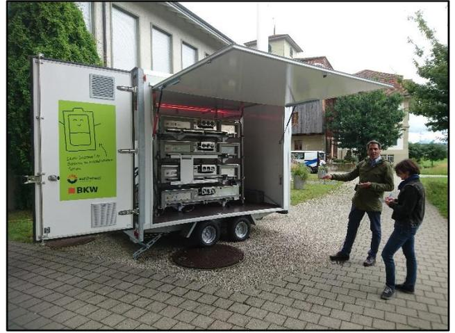
*Beispiel eines mobilen Containers mit 2nd-Use Batterien und einer bidirektionalen Ladestation zur Eigenverbrauchsoptimierung und für Peak-Shaving (Quelle: Dominik Müller)*
